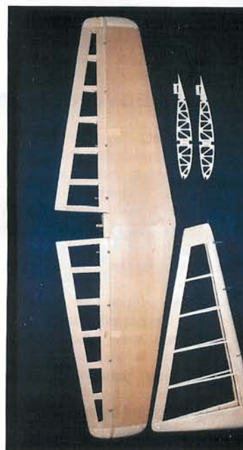
La commande de l'empennage monobloc nécessite deux servos indépendants de 40 N situés sur le stab. La dérive est commandée par un servo de 70 N.
