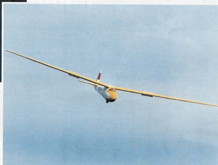
Le Ka6-CR de 6,50 m à l'atterrissage avec ses aérofreins sortis dessus et dessous!
